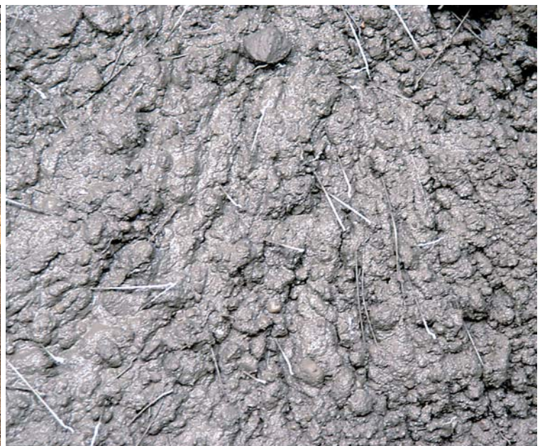
Die gleichmäßig und dreidimensional im Beton verteilten Stahlfasern verbessern gezielt die Betoneigenschaften
